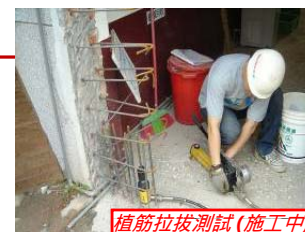
植筋拉拔測試 (施工前)
